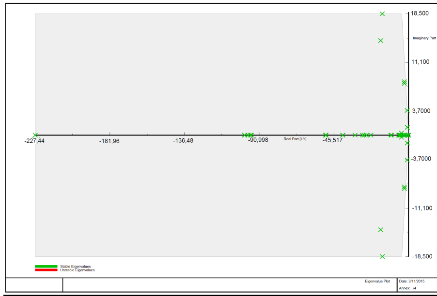
Figura 38: Autovalores del sistema Kundur con un HVDC-VSC multi-terminal obtenidos con PowerFactory, usando el método Arnoldi/Lanczos.
